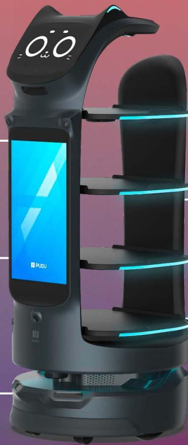
4 Ablagen mit Erkennung der Last per Induktionsablage
